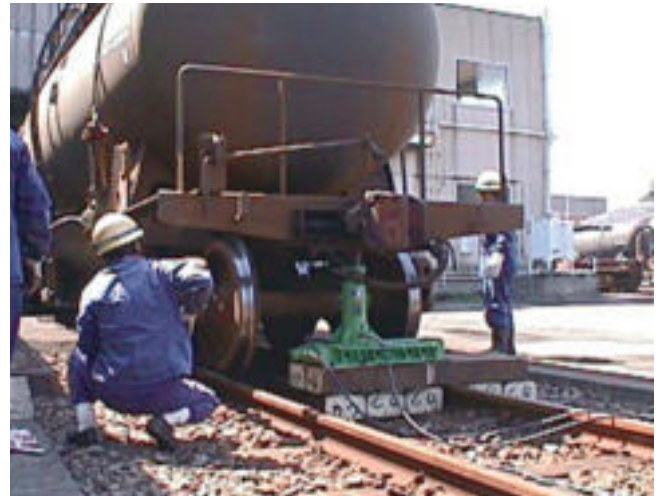
Гидравлический домкрат на скользящей опоре 500кН, 200мм и электрический насос
