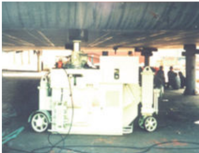
Устройство для регулировки местоположения корпуса судна 2000кН
