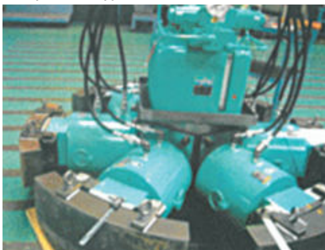
Гидравлический домкрат 3300кН, 50мм и электрическая насосная станция GH5-P
