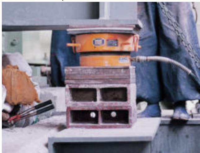
Ручной насос TWA-1.3-PG и низкий домкрат FN200S3 с фиксирующей гайкой
