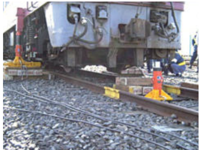
Гидравлический домкрат на скользящей опоре 200кН, 250мм и электрический насос GH1/2-P
