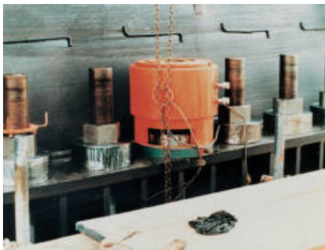
Гидравлический натяжитель болтов 5000 кН
