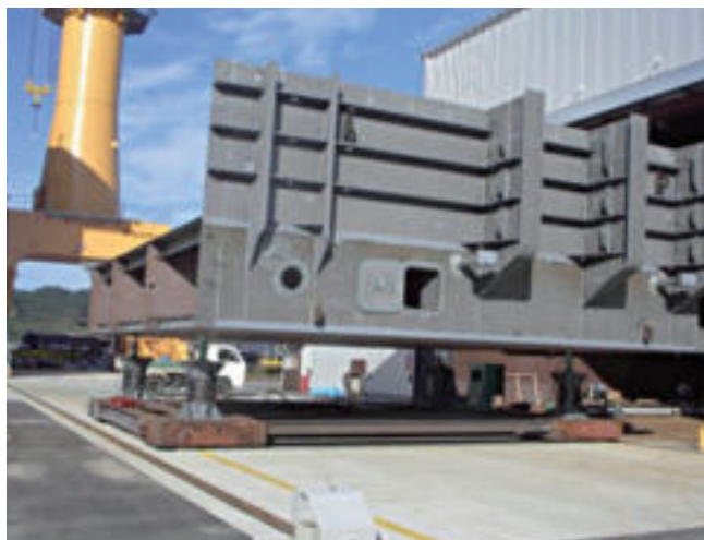
Гидравлический домкрат 500кН, 100 мм и электрическая насосная станция GH5-P
