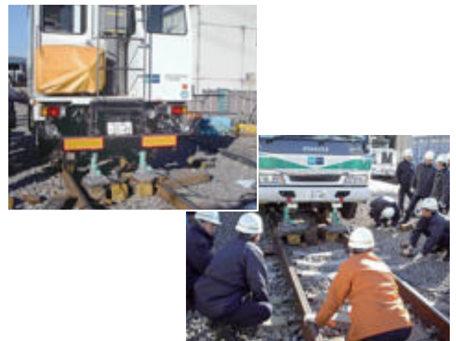
Гидравлический домкрат на скользящей опоре 230кН, 160мм и ручной насос TWA-0.7
