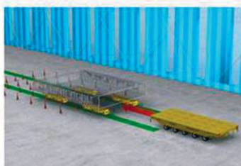
Подвести судовой транспортер под собранную секцию судна
