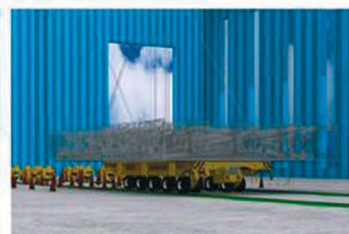
Переместить секцию судна судовым транспортером в покрасочный цех
