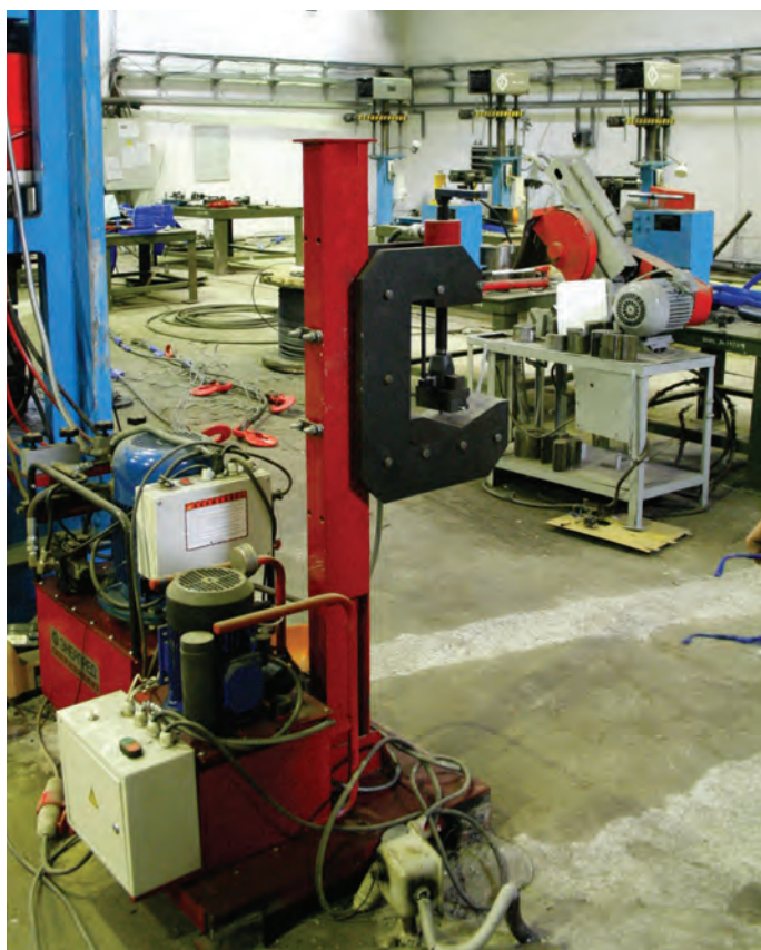
Установка клеймения гидравлическая УКГ-8П в цехе по производству стальных канатных стропов ОАО «Белорецкий металлургический комбинат»
