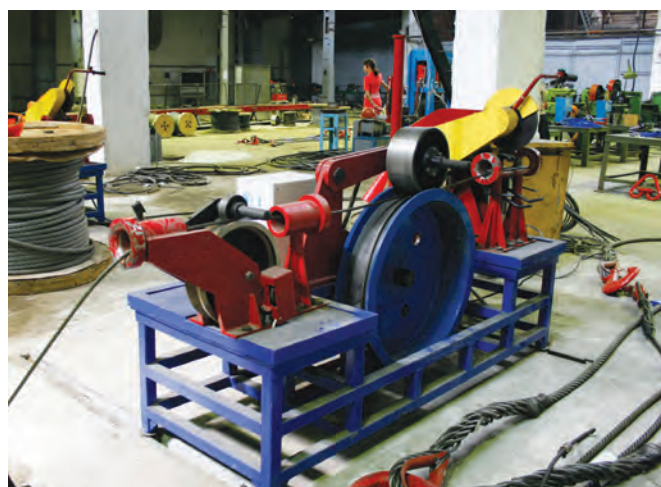
Установка УРКС-65 в цехе по производству стальных канатных стропов ОАО «Белорецкий металлургический комбинат»
