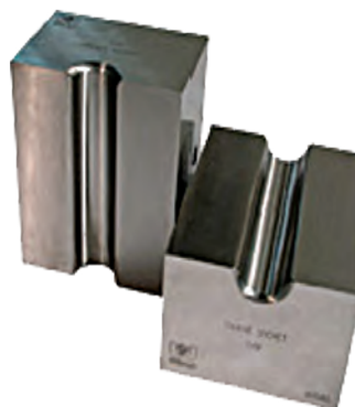
Открытые матрицы для опрессовки стальных втулок Flemish Eye методом 2-х стадийной опрессовки, 1-я стадия
