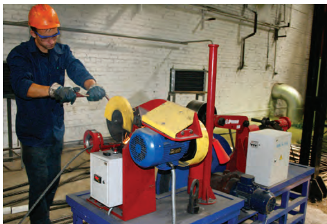
Перемотка и мерная резка каната на установке УРКС-65 в цехе по производству стальных канатных стропов ОАО «Белорецкий металлургический комбинат»
