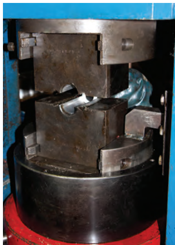
Монтаж матриц в пресс ППК-С400МА
