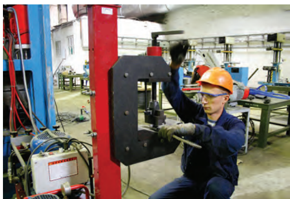
Маркировка стропа на обжимной втулке на оборудовании УКГ-8П в цехе по производству стальных канатных стропов ОАО «Белорецкий металлургический комбинат»
