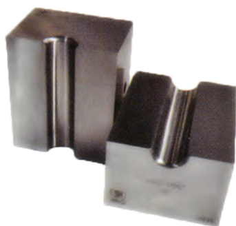
Матрицы для опрессовки концевых обжимных муфт
