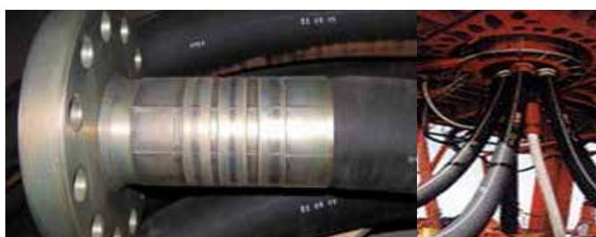
изготовление буровых рукавов нестандартных размеров до 25 метров включительно.
