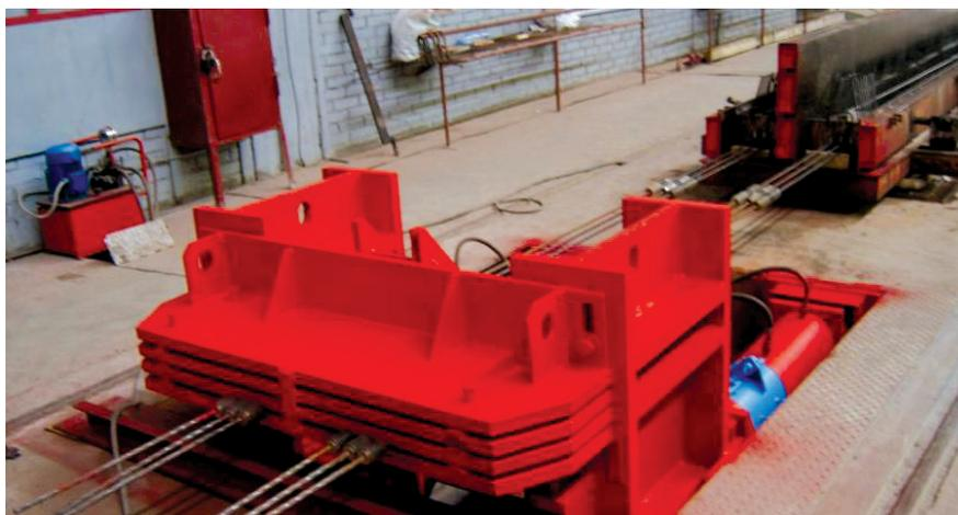
Стенд производства преднапряжённых Ж/Б конструкций
