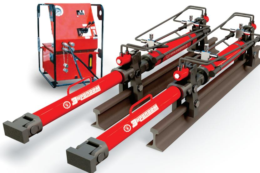
■ Основные составные части системы из двух толкателей: два силовых гидроцилиндра с гидравлическим возвратом поршня с зацепом удержания на штоках гидроцилиндров с гидроцилиндрами зажима, зацепом упора на донышках гидроцилиндров с гидроцилиндрами зажима, насосная станция, рукава высокого давления с быстроразъемными соединениями.
