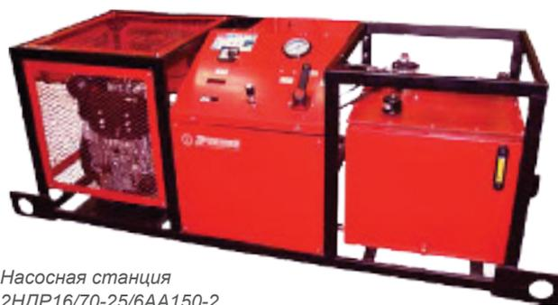
Оборудование серии «Горизонт» предназначено для продавливания стальных и железобетонных труб в грунтах 1-3 категории прочности при строительстве трубопроводов различного назначения, а также устройства футляров для прокладки инженерных коммуникаций.
